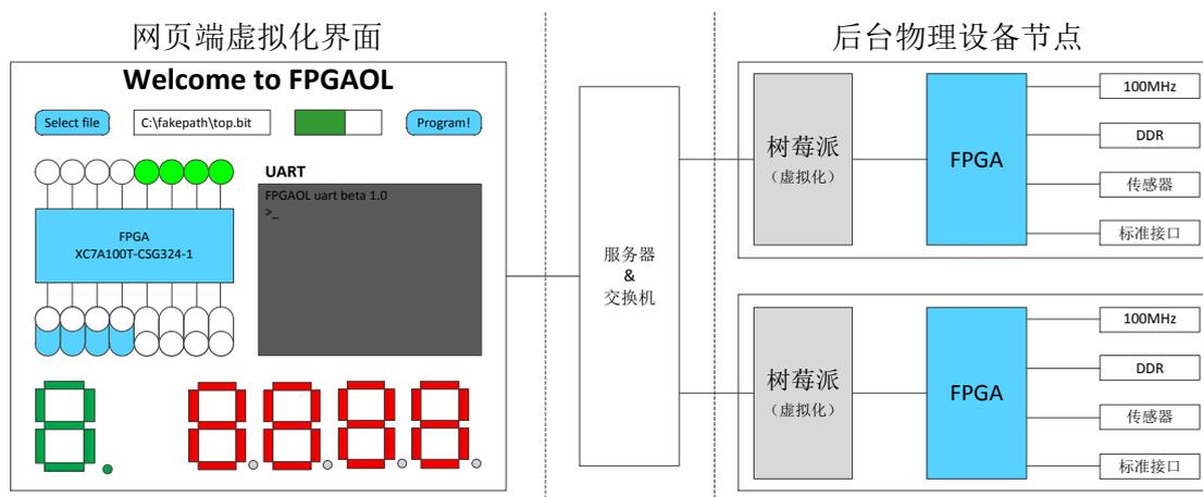
FPGAOL 平台的每个设备节点都包含了一个树莓派和一个 FPGA 板卡，树莓派与 FPGA 芯片的 26 个 IO 管脚直接相连，并最终映射到网页端，其中包括 8 个对应 LED（同时与七段数码管复用），8 个对应开关，7 个对应 8 位 16 进制数码管，1 个对应按键，2 个对应串口 UART。用户在网页端对虚拟化外设进行的操作都会通过树莓派映射到对应的 FPGA 管脚上。同理，FPGA 管脚的电平变化也会通过树莓派反应到网页端的虚拟化外设上。因此，用户是通过网页端的虚拟化外设实际地控制物理设备节点。
