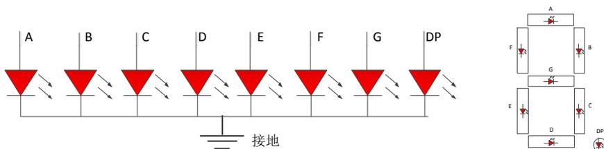
平台包含一个 8 位的十六进制数码管，该数码管共用 4bit 位宽的数据位，同时由 3bit 的选择位经译码后生成 8 个选择信号，控制 8
