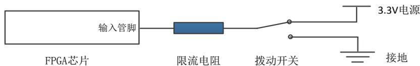
按键的工作原理与拨动开关类似，区别在于：按键按下时向 FPGA 芯片输入高电平信号，松开时输入低电平信号，按键默认处于松开状态。FPGAOL 1.0 实验平台中只有一个按键，且与 soft clock 功能复用（实际上 soft clock 功能暂未对用户开放）。
