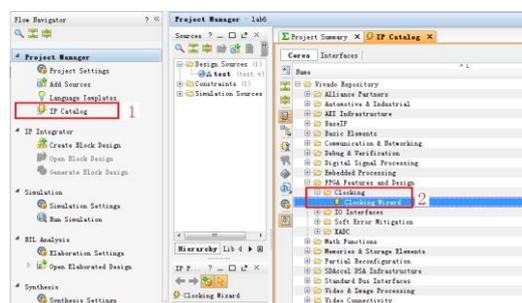
在弹出的窗口中, 对其进行设置, 输入时钟频率设置为 100MHz, 输出时钟有两个, 分别为 10MHz 和 200MHz。
