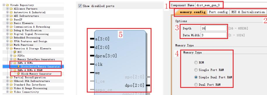
在存储器参数设置页面，用户可以对 IP 核名称、存储单元深度和位宽、存储器类型等进行设置。在页面的左侧是模块的端口图。在上图中，存储器深度设为  $16=2^4$ ，数据位宽为 3 位，因此地址信号为 4 位，数据端口位宽为 3。存储器类型选为简单双端口，因此包含了两套端口，其中 dpra、dpo 构成了读端口，d、a、clk、we 构成了写端口。在“RST&Initialization”页面，我们还可以通过后缀为 coe 的文件对存储器进行初始化，如下图右侧所示，coe 文件格式非常简单，可以以文本方式打开和编辑。其中“memory\_initialization\_radix=16”表示 coe 文件采用的是 16 进制方式显示，“memory\_initialization\_vector = ...”表示的是用 16 进制显示的初始化向量，下图右侧的示例表示，该存储器地址 0 内的数据为“23f4”，地址 1 内的数据为“0721”，以此类推。本例中的初始化文件内容为：
