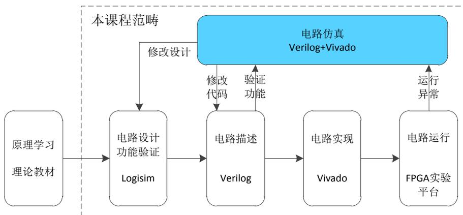
用 Verilog 完成电路的编码工作以后，如何确保电路功能正确呢？直接使用 Vivado 工具进行综合，并烧写到实验平台是一种最直接的办法，但是这种做法效率并不高，首先 Vivado 工具的综合过程比较慢，再者如果电路功能不正确，也无法快速定位问题所在，随着电路复杂度的增加，这一情况会更加凸显。因此我们更加推荐的是先通过 Vivado 提供的仿真功能对电路进行仿真。
