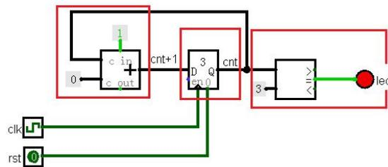
可以看出，该电路包含了 4 个状态 (0, 1, 2, 3)，电路在这 4 个状态之间循环跳转，其中加法器用于生成次态 (cnt+1)，寄存器将次态信号传递给现态 (cnt)，最后的比较器通过现态信号生成输出信号 (led)。它虽然没有按着有限状态机的三段式格式来写，但确实是一个摩尔型有限状态机。
