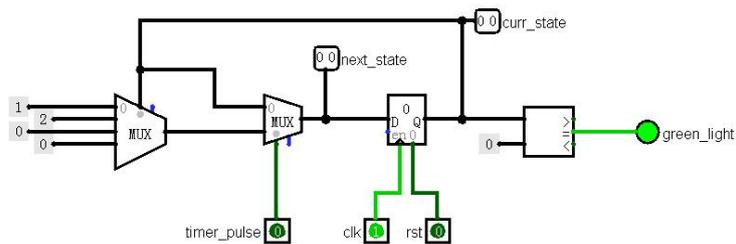
实际上，通过同样的方式还可以控制其它输出信号，如“转换”状态时黄灯亮，“停止”状态时红灯亮。
