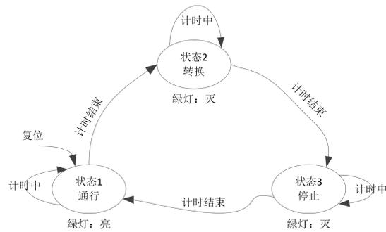
交通灯有红黄绿三种颜色，分别代表停止、转换、通行三种状态，交通灯通过计时信号控制状态在这三者之间不断转换。计时结束前，将保持原状态，计时信号出现后，会跳转到下一状态，如从“通行”状态跳转到“转换”状态。绿灯在“通行”状态下灯亮，另外两个状态下灯灭。如果用电路实现该交通灯的功能，其输入信号为计时信号（timer\_pulse），该信号为持续一个时钟周期的脉冲信号，输出信号为绿灯（green\_light）。电路包含 3 种状态 (PASS、TRANS、STOP，分别用 2'b00, 2'b01, 2'b10 表示)，复位状态为“PASS”。电路端口为：
