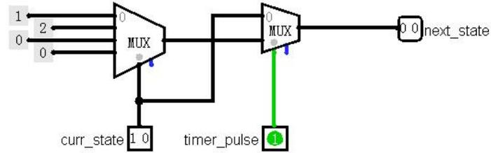
在上述电路的基础上，添加寄存器，在每个时钟的上升沿将 next\_state 信号赋值给 curr\_state 信号。
