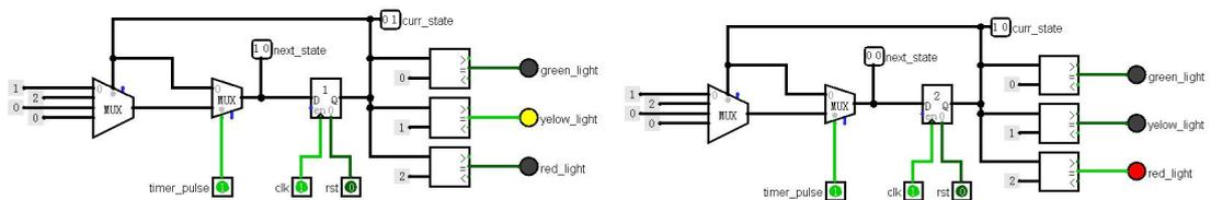
至此，我们完成了用有限状态机实现交通灯控制的电路设计。该电路是一个典型的摩尔型有限状态机，电路各部分与有限状态机结构对应关系如下图所示。
