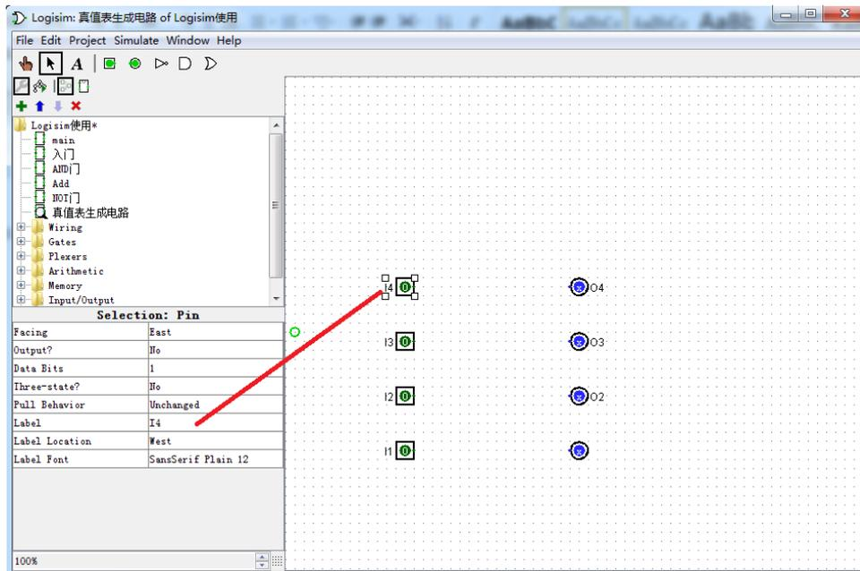
在菜单栏的“Project”选项卡中找到“Analyze Circuit”选项，并选中。在弹出的窗口中选择“Table”选项，按照前面的真值表修改输出值(鼠标点击输出信号对应的叉号就可修改)，最后点击“Build Circuit”便可生成电路(弹出的对话框都选择“是”)。
