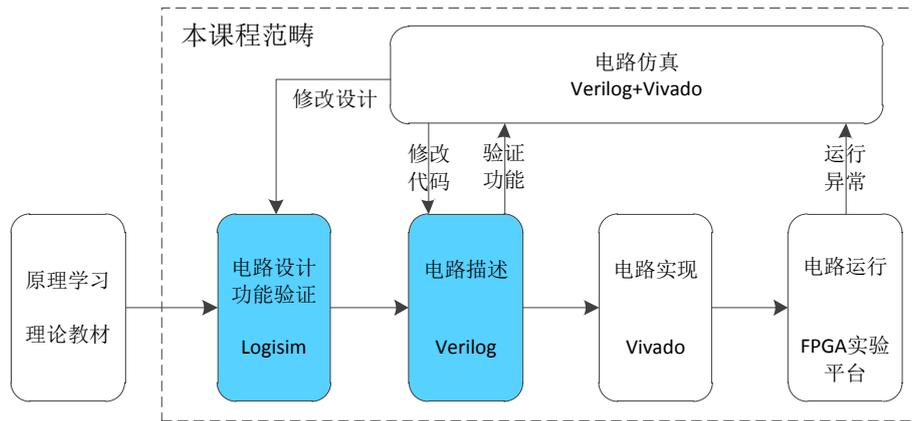
Logisim 可以用来搭建数字逻辑电路并对其功能进行仿真，有助于初学者直观的掌握电路原理及内部构造，以达到快速入门的目的，是一款非常实用的教学工具，但是它的功能仅限于仿真，是对实际电路行为的模拟，而不是真真正正的电路。为了将设计的电路切实的在硬件上运行，我们还需要借助硬件描述语言、综合工具、硬件平台的支持。本次实验中我们会介绍到一种叫做 Verilog HDL 的硬件描述语言，工具及平台我们会通过后续的课程逐步介绍。
