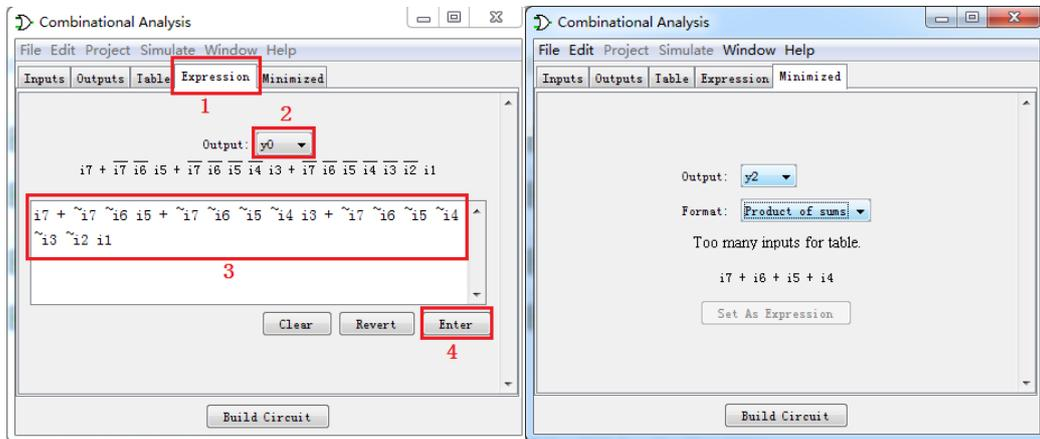
我们可以在 Logisim 中直接输入表达式生成电路，在“Project”-->“Analyze Circuit”的弹出窗口中选择“Expression”选项，填入每个输出信号的表达式。最后点击“Build Circuit”生成电路。有时候手动输入的表达式并不是最简形式，最终生成的电路也会占用较多的逻辑门，我们可以借助“Minimized”选项卡对表达式进行简化，进而减少电路使用的逻辑门数量，电路输入信号不多的情况下，该窗口还能显示卡诺图。下图对比了同一功能电路未化简的电路结构和化简后的与或式和或与式结构，可以看出占用逻辑门数量有明显差异。
